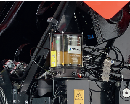
5. Otomatik gresleme sistemi
