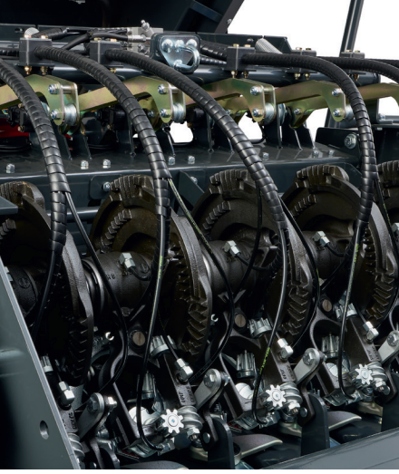
1. Standart elektronik izlemeli çift düğümleme sistemi
