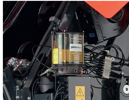
5. Otomatik gresleme sistemi
