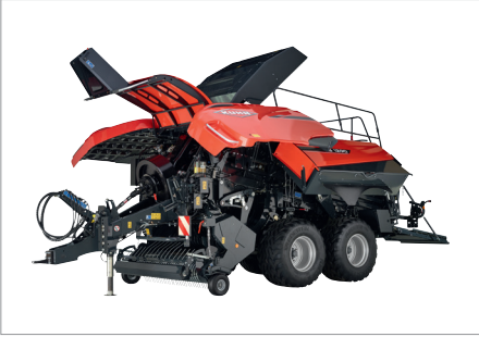
2. Bakım işlemlerini kolaylaştırmak için ip sandıklarının döndürülmesi
