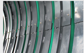
Ön hazne için kolay akış plakaları
