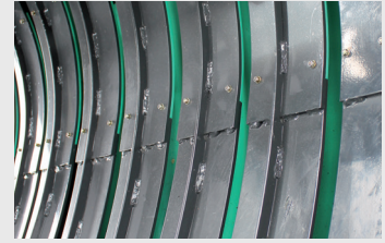
Ön hazne için kolay akış plakaları
