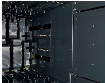
3. Değiştirilebilir, aşınmaya karşı yüksek mukavemette balya kanalı parçaları
