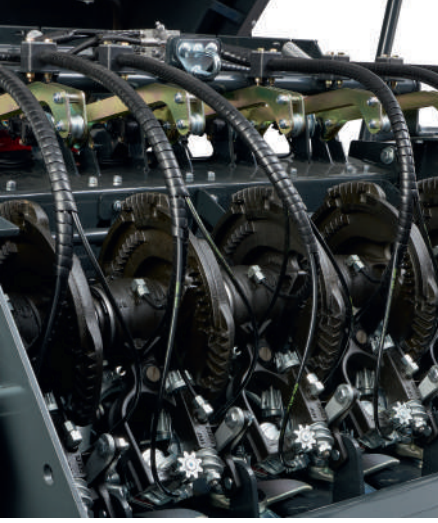
1. Standart elektronik izlemeli çift düğümleme sistemi
