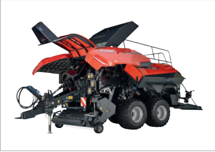
2. Bakım işlemlerini kolaylaştırmak için ip sandıklarının döndürülmesi
