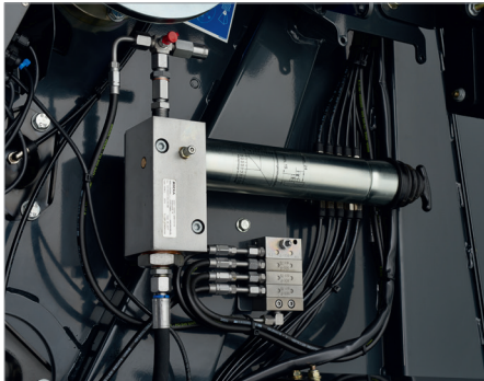
5. Makaralı rulmanlar için standart otomatik yağlama sistemi
