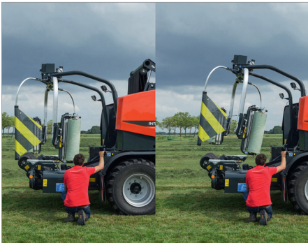
8. VBP 7190: 1,60 m'den büyük balyaları boşaltmak için entegre sarıcı ayan
